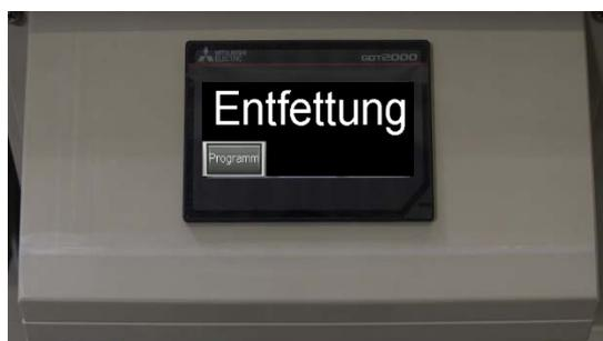
Prozessbedientableau zur Prozesssteuerung (Beispiel: Entfettung)
